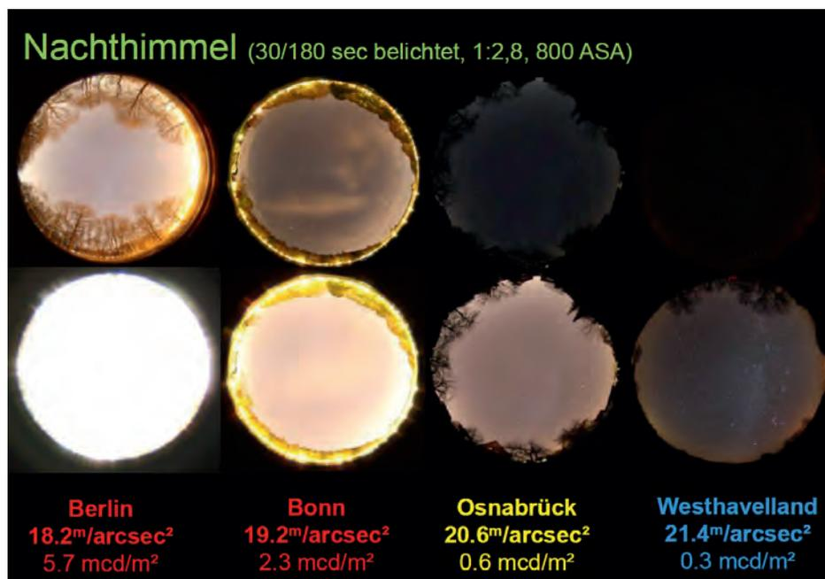
Aufnahmen mit Belichtungszeiten von 30 (obere Reihe) und 180 Sekunden (untere Reihe) bei sonst gleichen Kameraeinstellungen.
